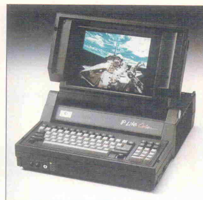
Bild 4. Robust: Der fast 10 kg schwere IP Lite übersteht einen Fall aus 1 m Höhe.
