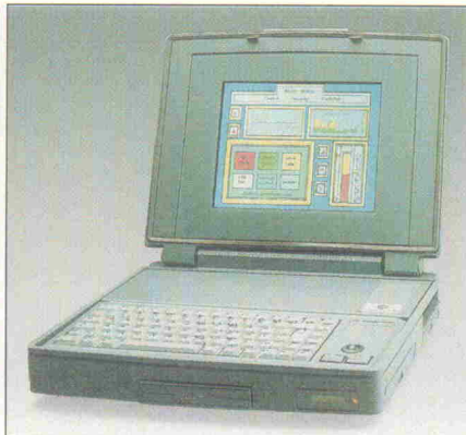
Bild 2. Hart im Nehmen: Kontrons IN Lite ist im geschlossenen Zustand IP-64-fest.
