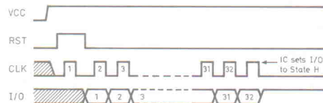
Bild 4. Aufgewecktes Kärtchen: Nach dem Rücksetzen liefert eine ISO-Karte den Answer-To-Reset-(ATR)-Header, 32 Datenbits, die ihre Funktionalität beschreiben.
