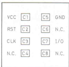
Bild 3. Entree: ISO 7816-2 schreibt die Anschlußbelegung für Chipkarten vor.
