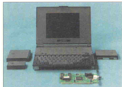
Bild 1. Unter-geschoben: Eine 2/3-lange ISA-Karte paßt genau unter die Tastatur des CardStar.
